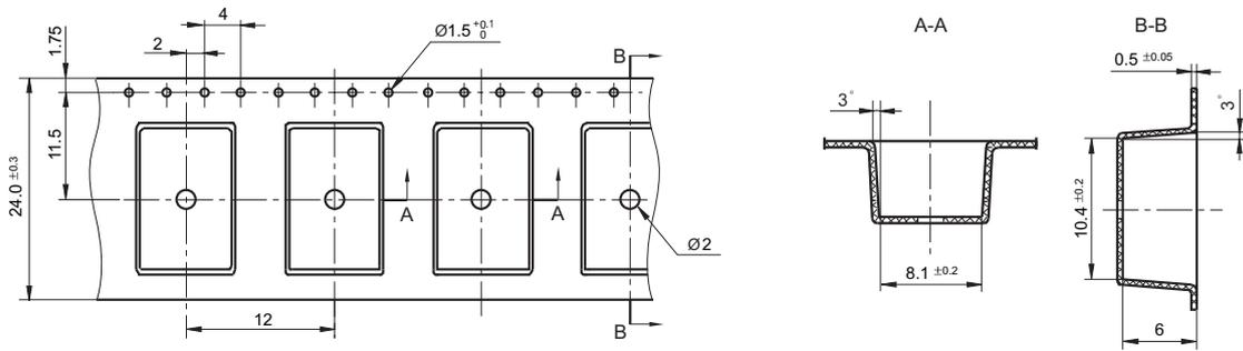
载带外形图 (S1型: 短脚表面贴装型)
