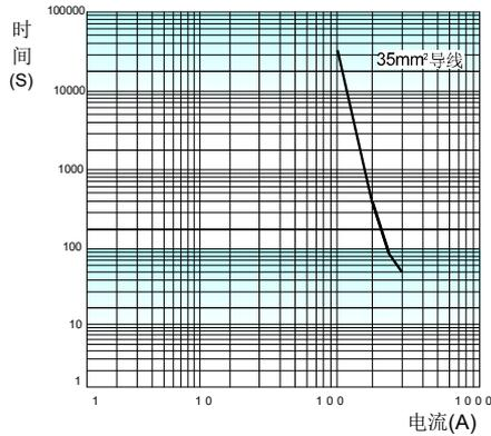
备注:以上数据在常温下测得,仅作参考,请勿直接用于选择熔断器。
